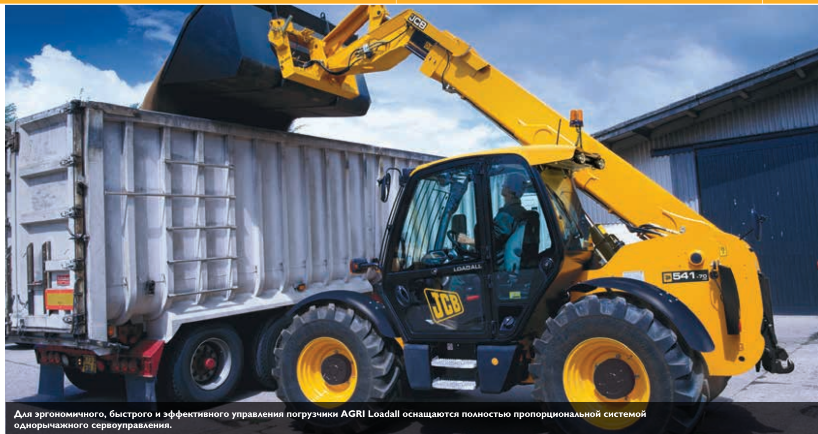
Система амортизации стрелы Smoothride System (SRS) компании JCB нейтрализует ударную нагрузку стрелы.
