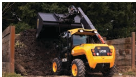
Система JCB Adaptive Load Control автоматически предотвращает опрокидывание машины вперед при работе с тяжелыми грузами.
