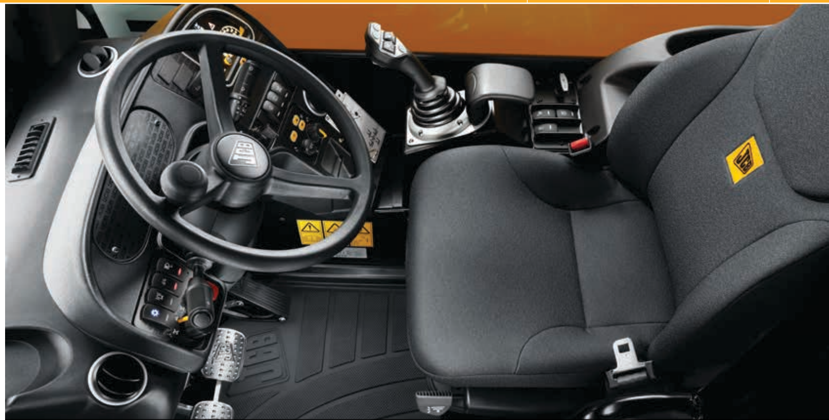
Для эргономичного, быстрого и эффективного управления погрузчики AGRI Loadall оснащаются полностью пропорциональной системой однорычажного сервоуправления.
