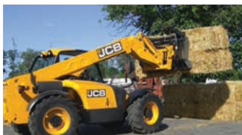
Система амортизации стрелы Smoothride System (SRS) компании JCB нейтрализует ударную нагрузку стрелы.
