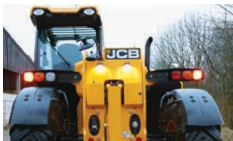
Машины AGRI Loadall с высотой подъема 7 м и больше оснащаются складными задними фарами.
